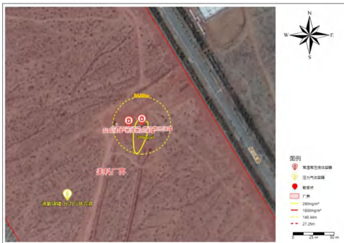
图 7.5-19 最常见气象条件下次氯酸钠溶液储罐泄漏环境影响范围
